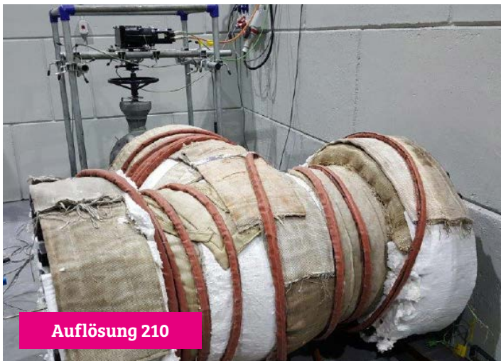
Bild 3: Aufbau mit der Haubenmessmethode
