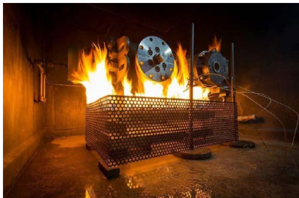
Bild 6: Nicht nur unter kryogenen Bedingungen wird getestet - im Labor können bis zu 800 ° C erzeugt werden
